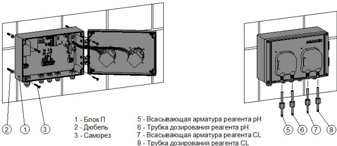
Рис.4.2-4 Установка Блока П с перистальтическими насосами для реагентов pH и CL
