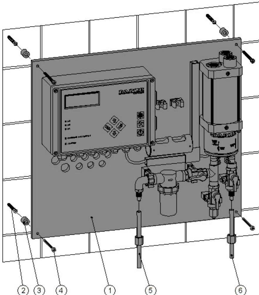
Рис.4.2.2 Установка панели управления с контроллером и измерительной ячейкой
