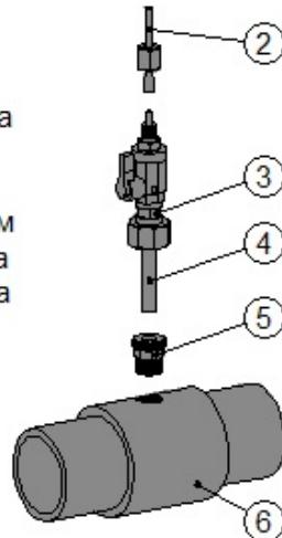
Рис.4.2-3 Установка клапанов впрыска реагентов
