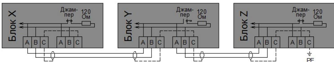
Рис.4.3-1 Соединение блоков для создания шины обмена данными RS-485
