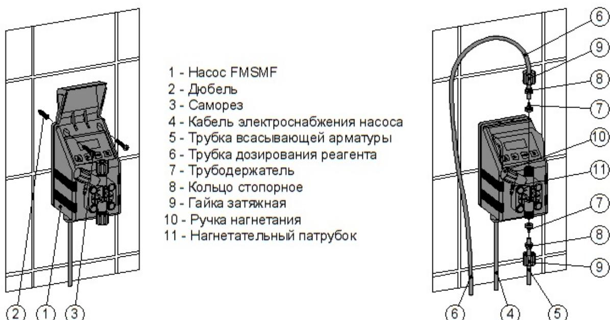
Рис.4.2-7 Установка мембранных дозирующего насоса FMSMF
