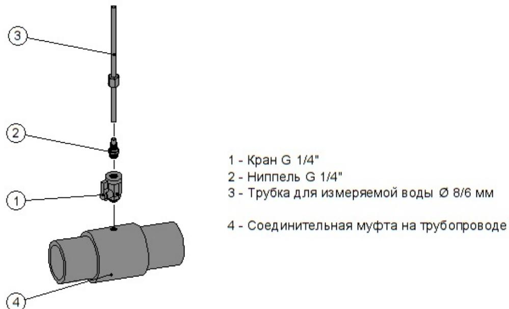
Рис.4.2.1 Установка крана для измеряемой воды
