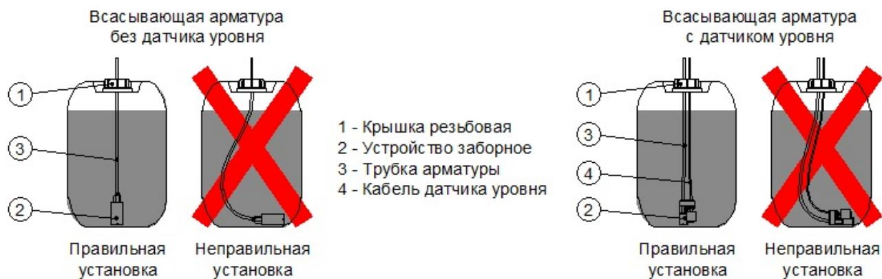
Рис.4.2-11 Установка всасывающей арматуры насоса в расходную канистру
