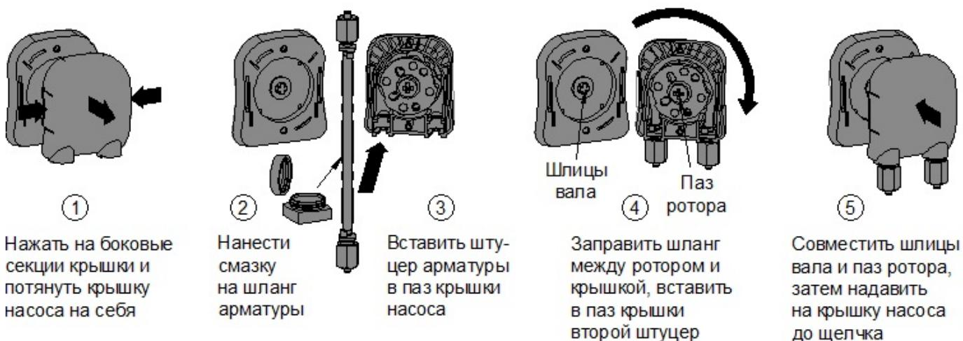
Рис.4.2-5 Установка шланговой арматуры в перистальтический насос
