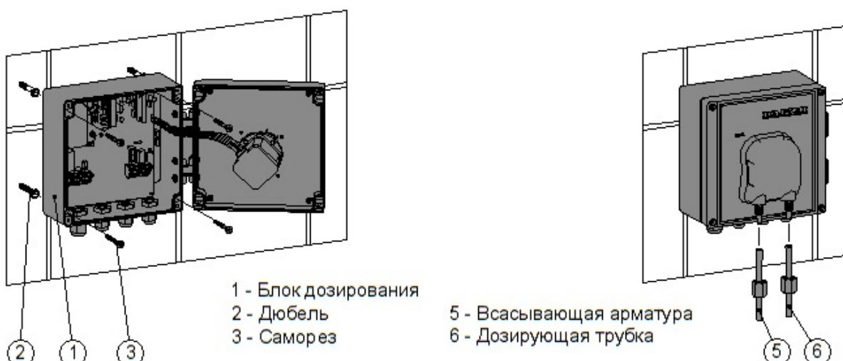
Рис.4.2-8 Установка Блока дозирования коагулянта или альгицида
