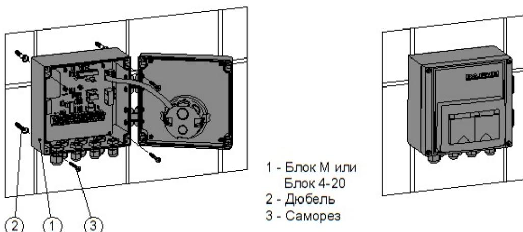
Рис.4.2-6 Установка Блока М или Блока 4-20 для внешних дозирующих насосов реагентов pH и CL
