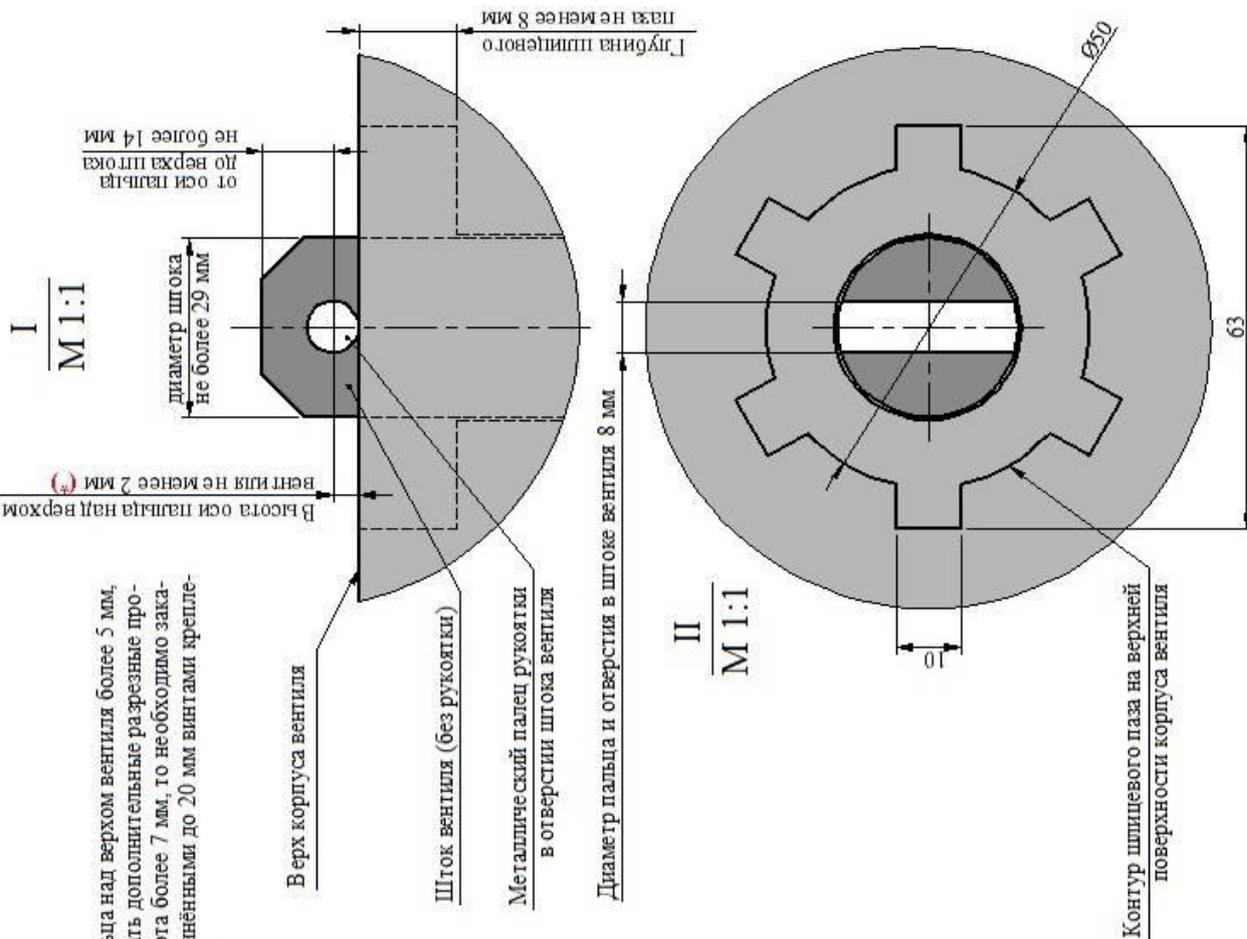
(\*) Если высота оси пальца над верхом вентилей более 5 мм, то необходимо заказать дополнительные разрезные прокладки; если эта высота более 7 мм, то необходимо заказать блок Авто с удлинёнными до 20 мм винтами крепления опорной стойки.
