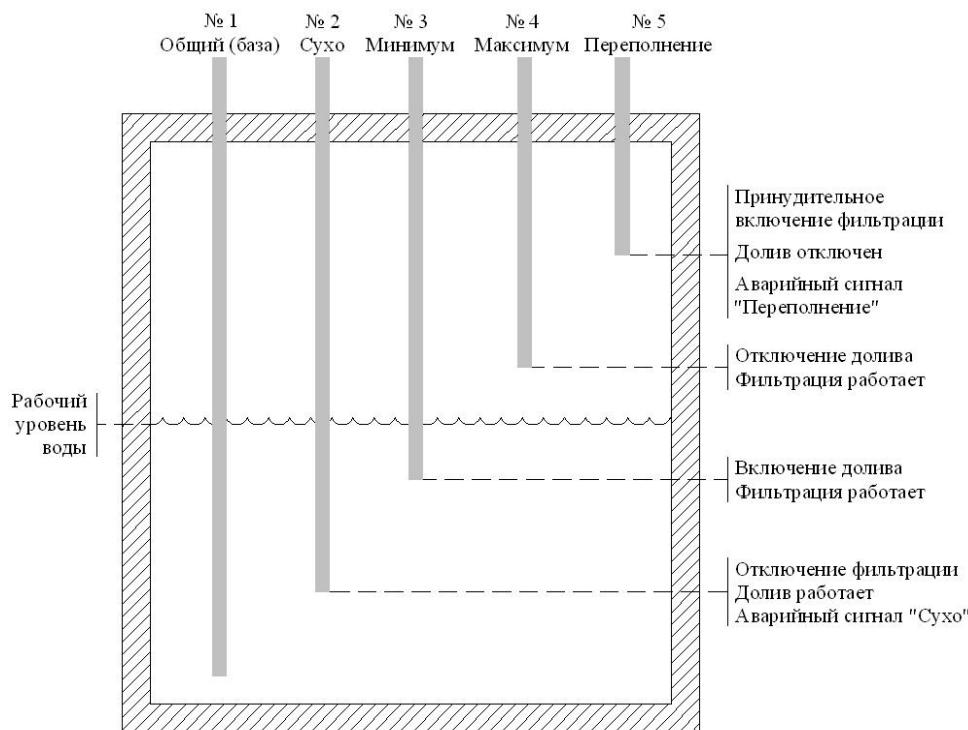
Для бассейна **скimmerного типа**, используются клеммы: №№ 1,2,3 в зависимости от заданного в пункте 6.4.6.8. типа используемого датчика уровня воды.
