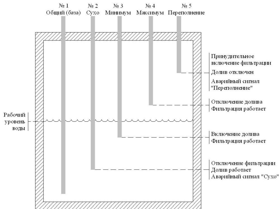
Для бассейна **скimmerного типа**, используются клеммы: №№ 1,2,3 в зависимости от заданного в пункте 6.4.6.9. типа используемого датчика уровня воды.
