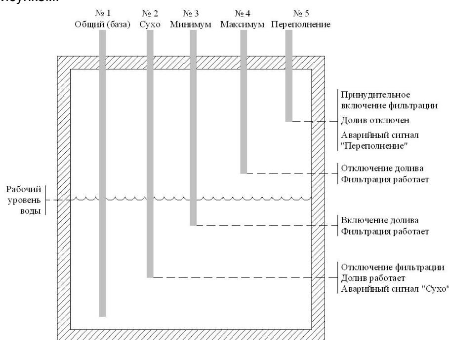
Для бассейна **скimmerного типа**, используются клеммы: №№ 1,2,3 в зависимости от заданного в пункте 6.4.4.7. типа используемого датчика уровня воды.
