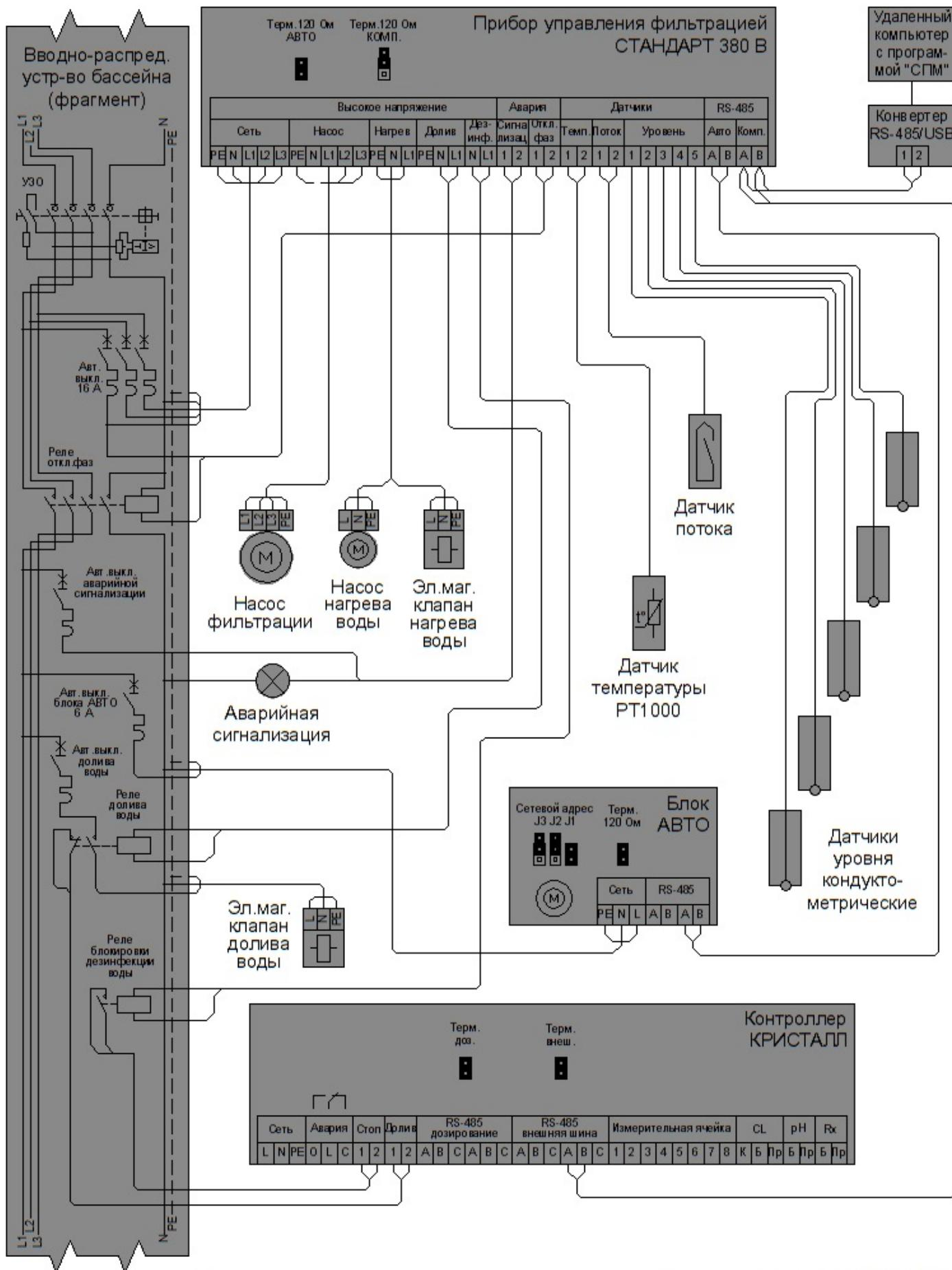
Схема подключения питания и исполнительных устройств к прибору СТАНДАРТ 380 В
