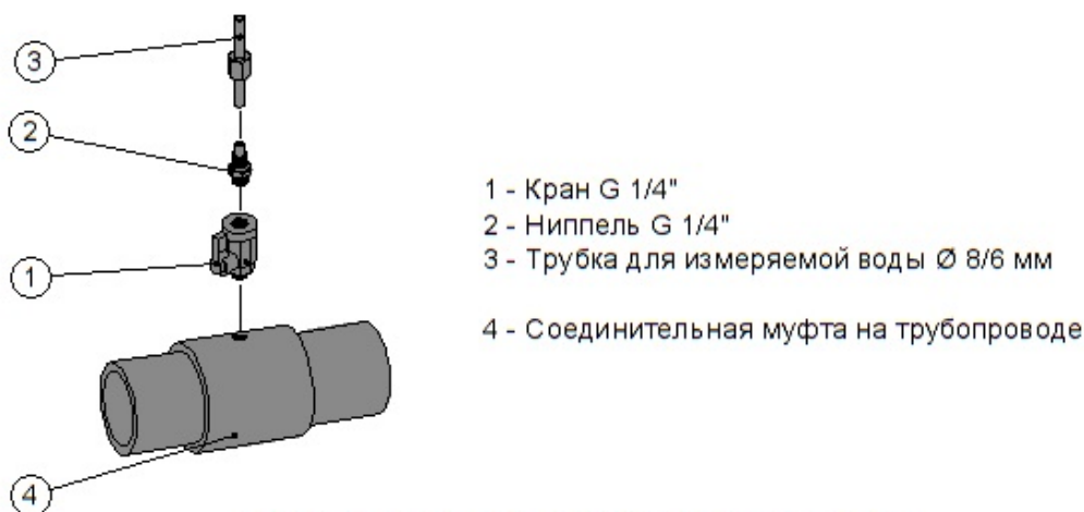
Рис.4.2-4 Установка крана для измеряемой воды
