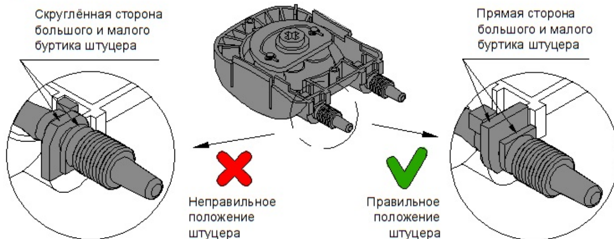
Рис. 4.2-3 Установка шланговой арматуры в перистальтический насос
