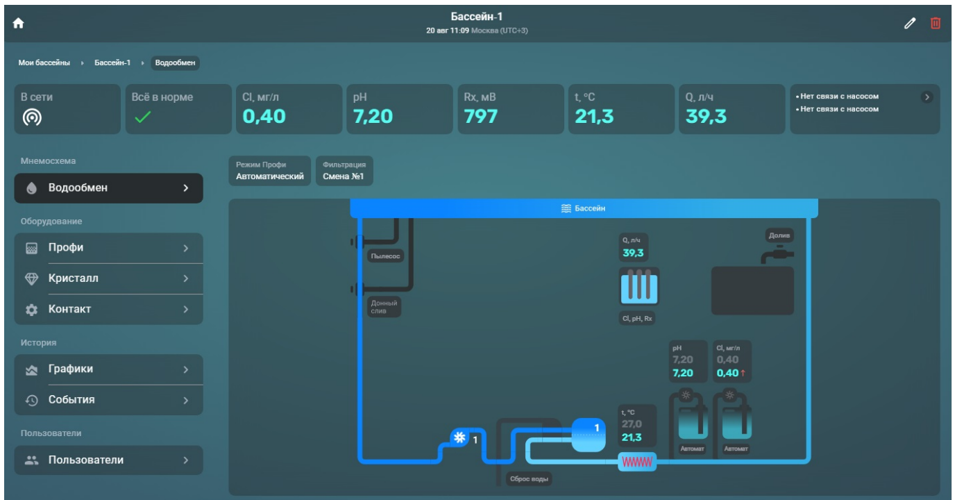
Рис.П1-1 Пример окна интерфейса для удалённого управления оборудованием бассейна
