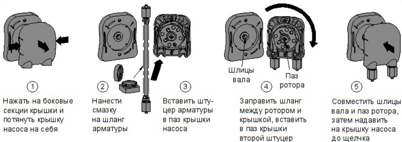
Рис.4.2-2 Установка Блока П с перистальтическими насосами для реагентов рН и CL
