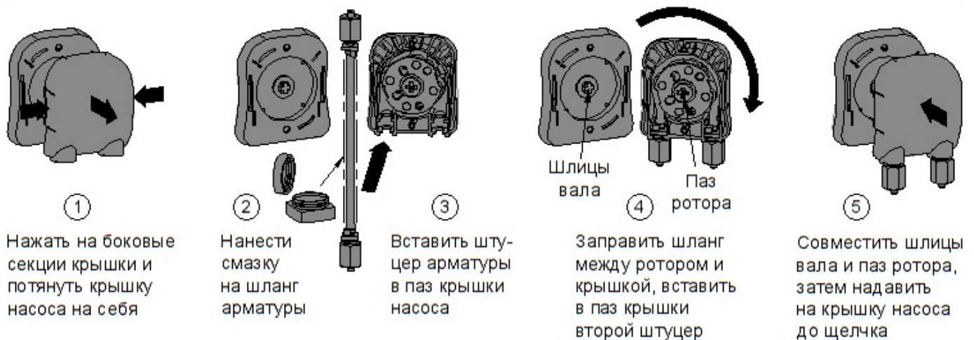
Рис.4.2-2 Установка Блока П с перистальтическими насосами для реагентов pH и CL
