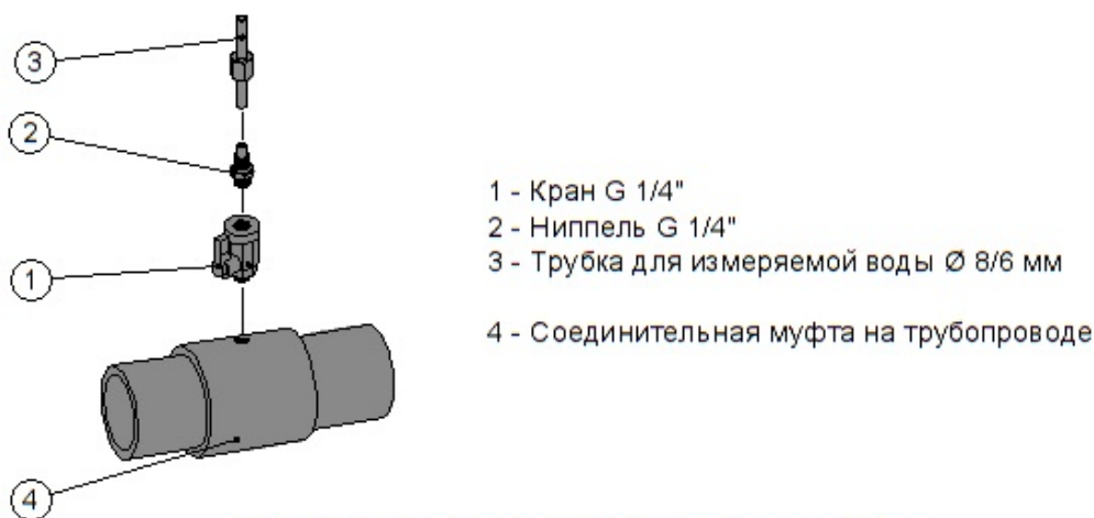
Рис.4.2-4 Установка крана для измеряемой воды
