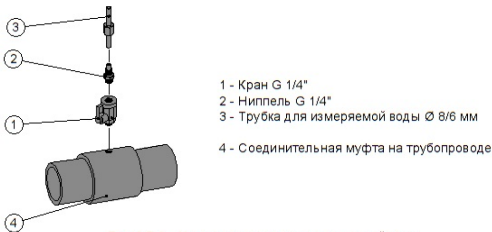
Рис.4.2-4 Установка крана для измеряемой воды
