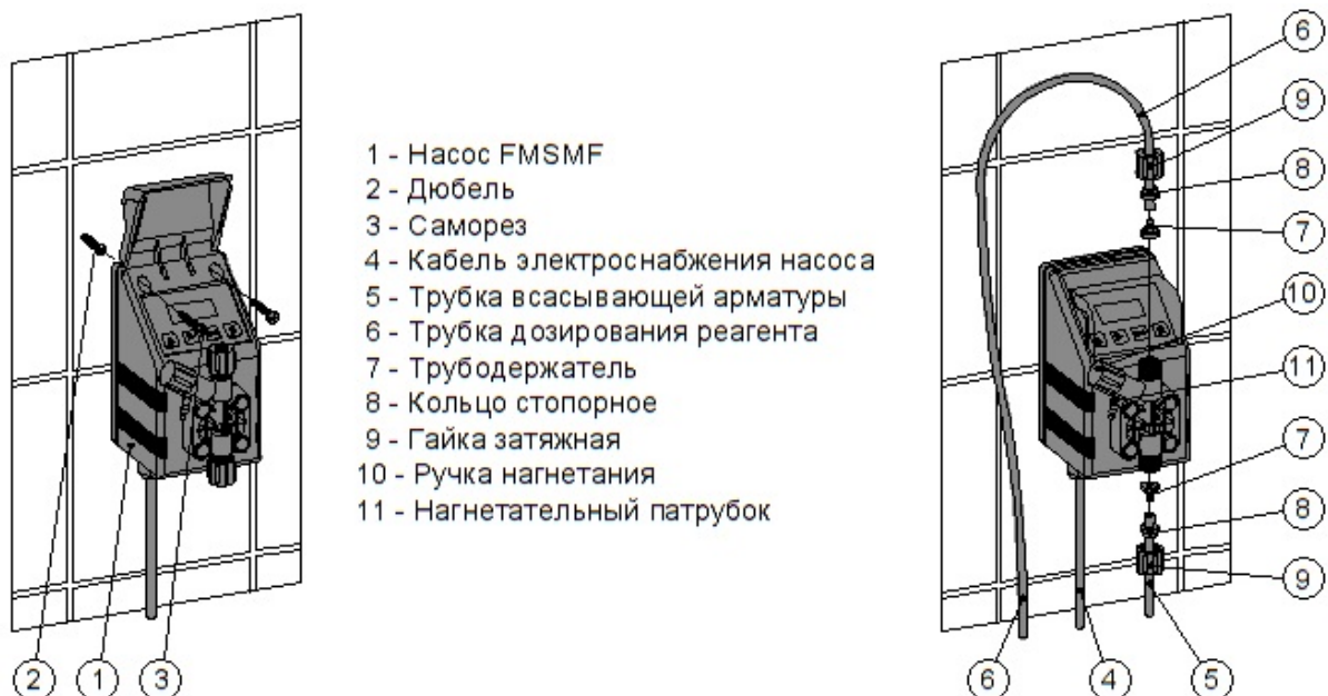
Рис.4.2-3 Установка мембранного дозирующего насоса VFMS MF
