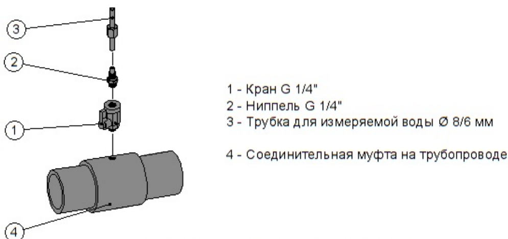
Рис.4.2-4 Установка крана для измеряемой воды
