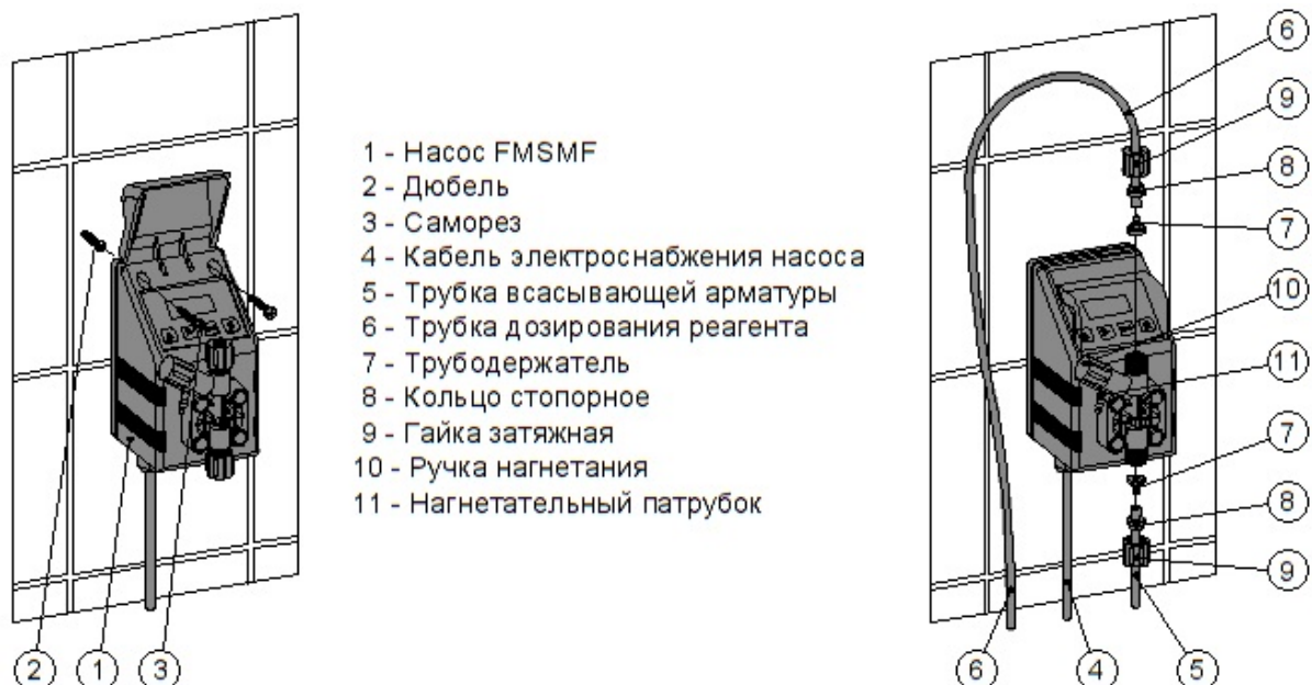
Рис.4.2-3 Установка мембранного дозирующего насоса VFMS MF
