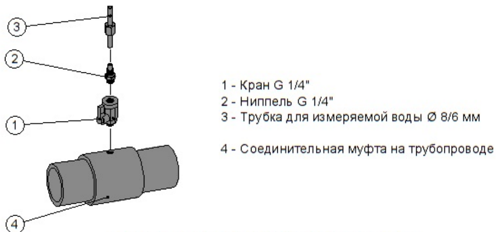
Рис.4.2-4 Установка крана для измеряемой воды
