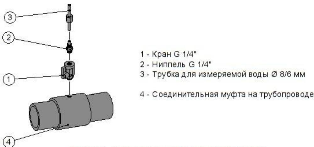
Рис.4.2-4 Установка крана для измеряемой воды
