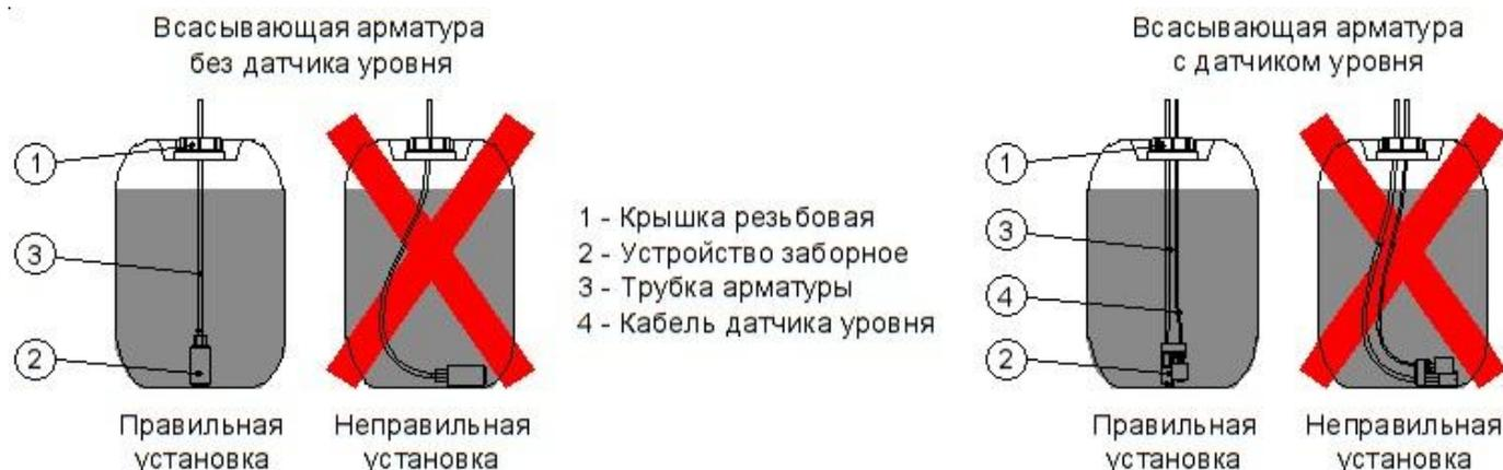
Рис.4.2-8 Установка всасывающей арматуры насоса в расходную канистру
