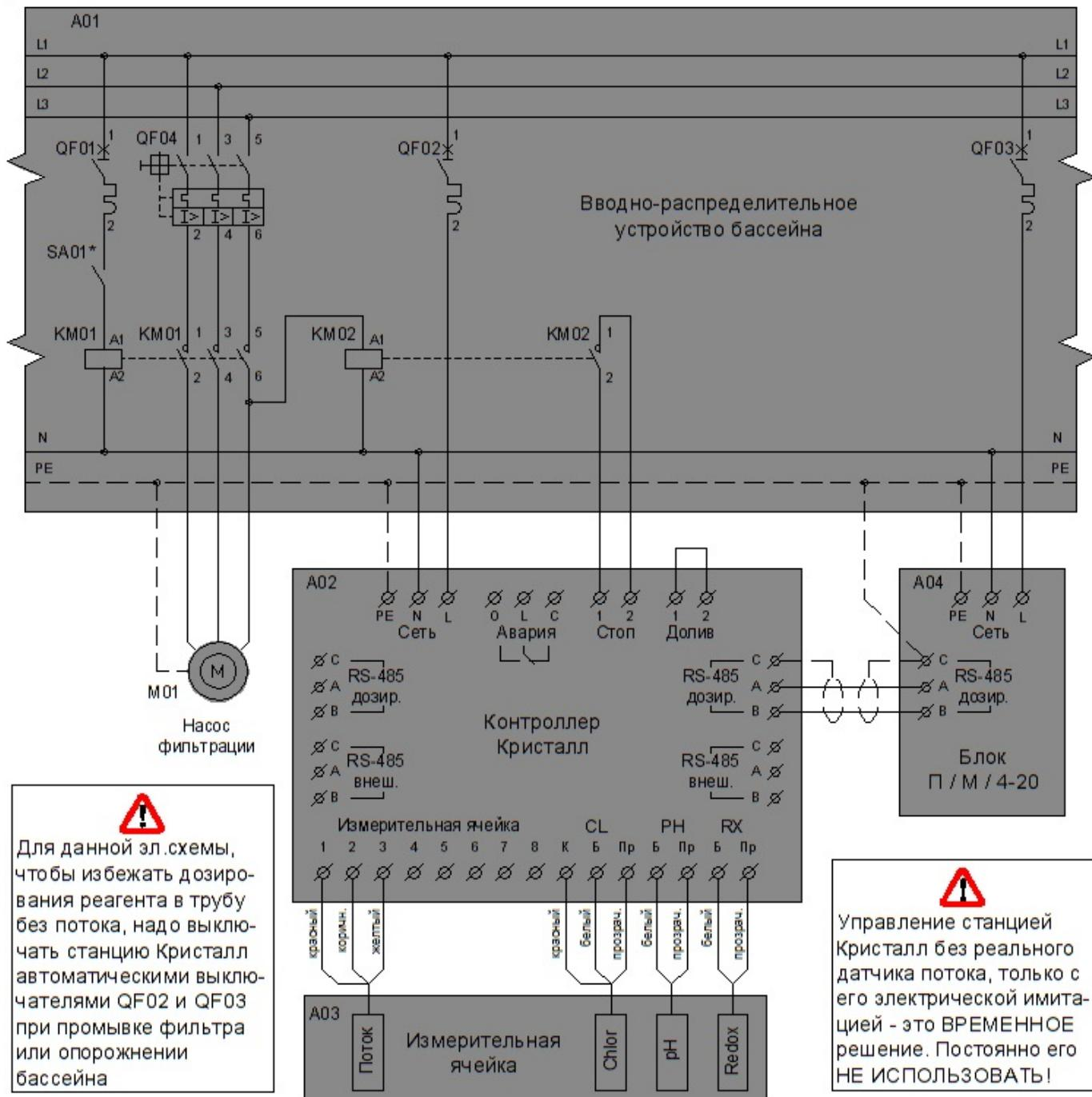
Рис.П2-1 Схема установки контактора KM02 для имитации сигналов датчика потока
