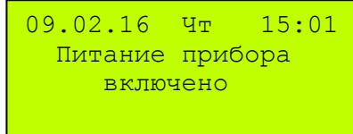
На дисплее контроллера появится сообщение о включении питания, будет выполнена проверка связи контроллера с прочими агрегатами станции и появится предложение подождать 20 минут до запуска станции в автоматическую работу. Это ожидание требуется для адаптации измерительных электродов к воде при повторном включении уже настроенной станции.
