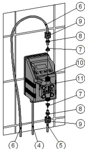
Рис.4.2-3 Установка мембранныго дозирующего насоса VFMS MF
