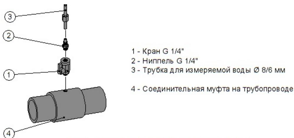
Рис.4.2-4 Установка крана для измеряемой воды
