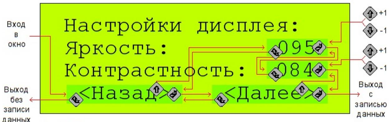
Рис.П3-6 Навигация по элементам окна просмотра/изменения настроек
