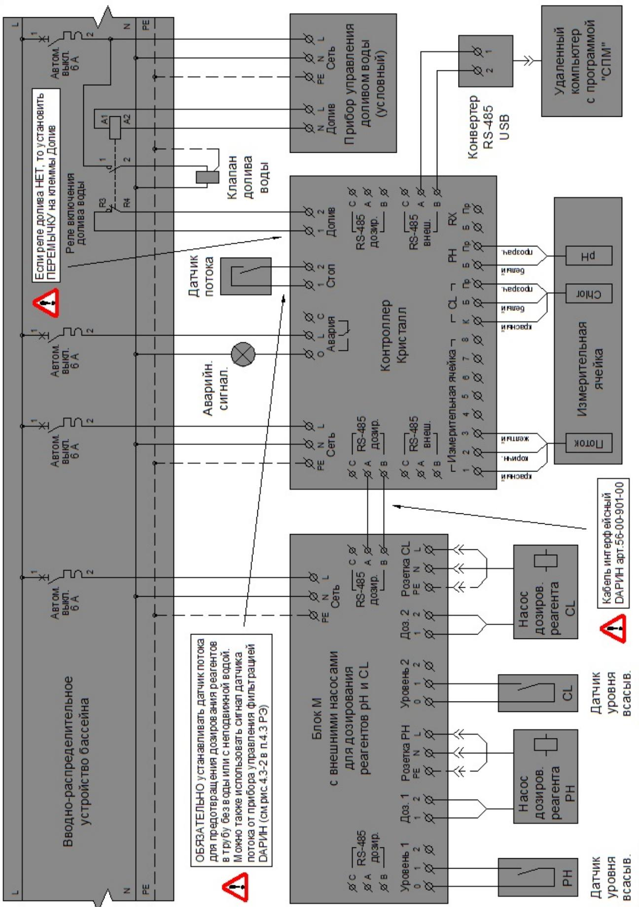
Рис.4.3-1 Схема электрического подключения оборудования Кристалл М : CL, pH
