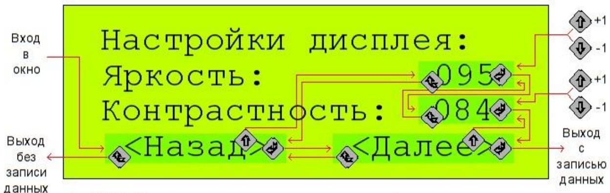
Рис.П3-6 Навигация по элементам окна просмотра/изменения настроек
