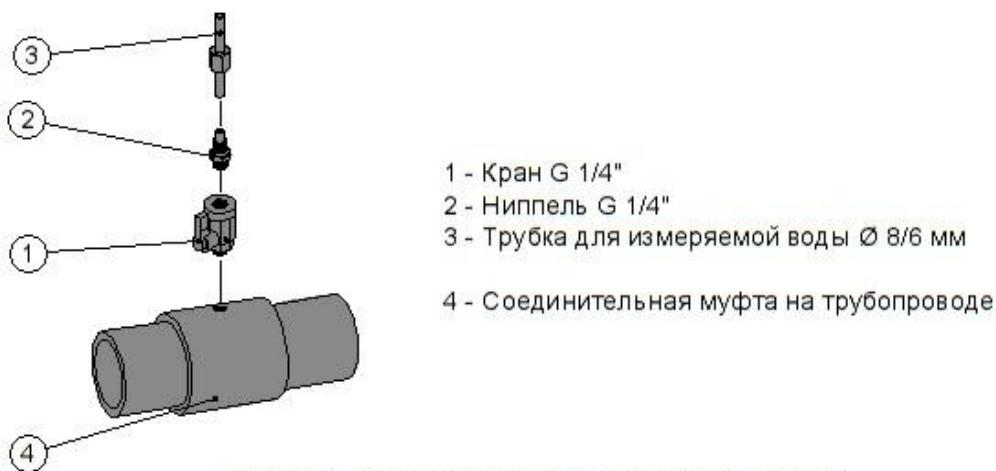
Рис.4.2.4 Установка крана для измеряемой воды
