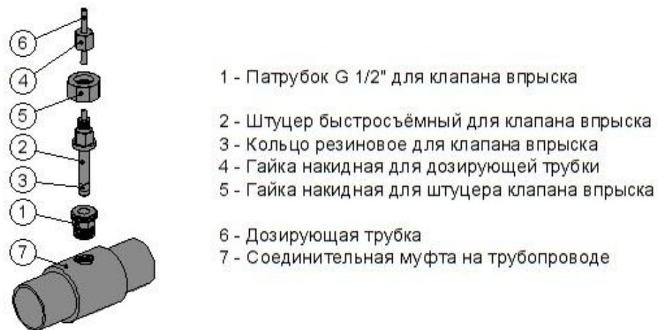
Рис.4.2.5 Установка быстросъёмного клапана впрыска реагентов
