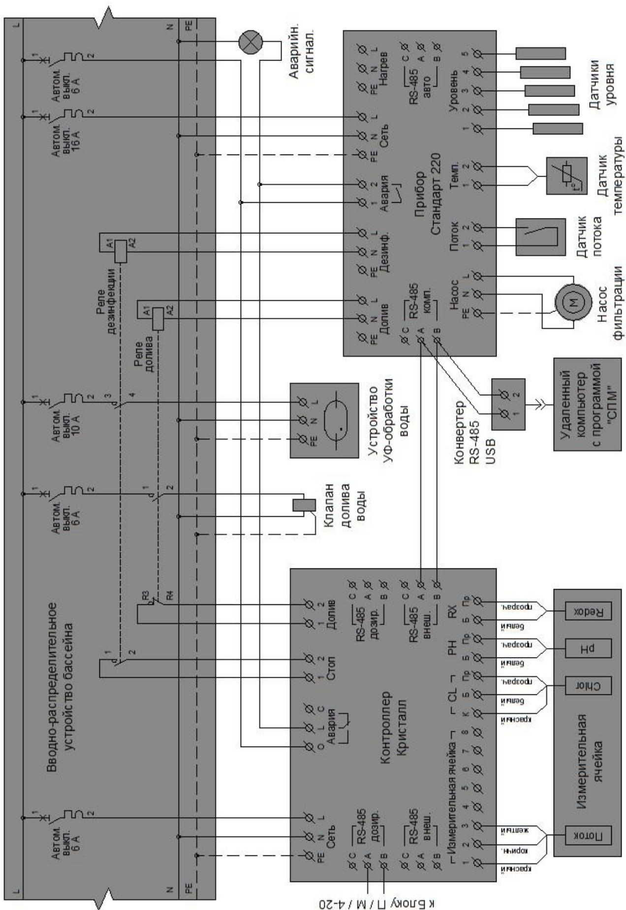
Использование сигналов приборов ДАРИН Стандарт/ПрофИ/Мас тер/Моно для управления станцией Кристалл Рис.4-3-2
