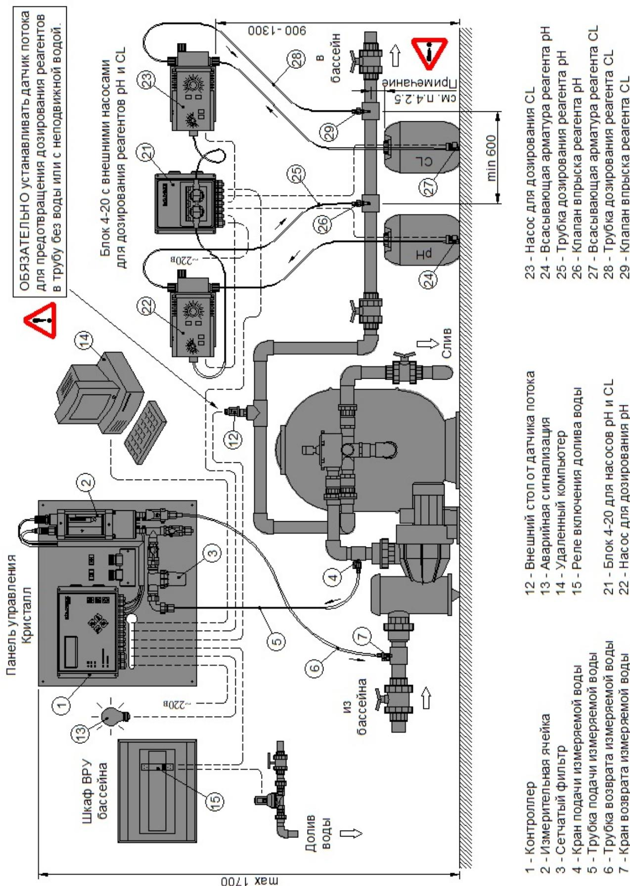
Рис. 2-1 Схема размещения оборудования Кристалл 4-20
