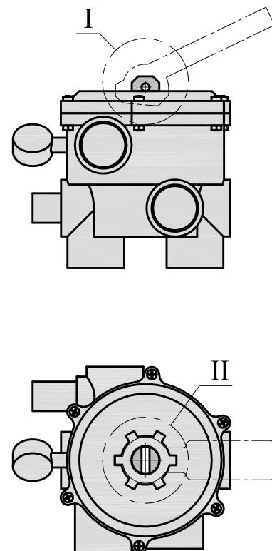
(\*) Если высота оси пальца над верхом вентиля более 5 мм, то необходимо заказать дополнительные разрезные прокладки; если эта высота более 7 мм, то необходимо заказать блок Авто с удлинёнными до 20 мм винтами крепления опорной стойки.
