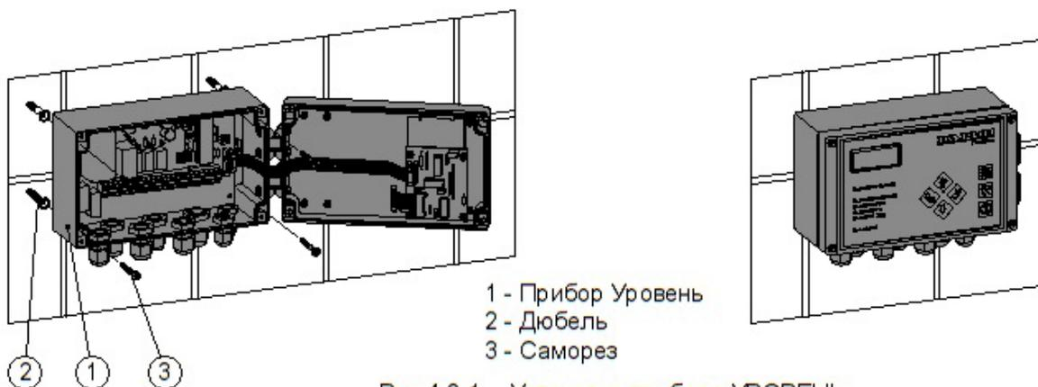
Рис.4.2-1 Установка прибора УРОВЕНЬ
